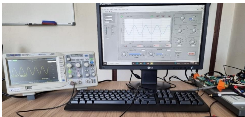
Фигура 4.17. Експериментална постановка на системата за генериране и измерване на сигнали при активиран лентов филтър и зададен от функционалния генератор синусоиден сигнал
