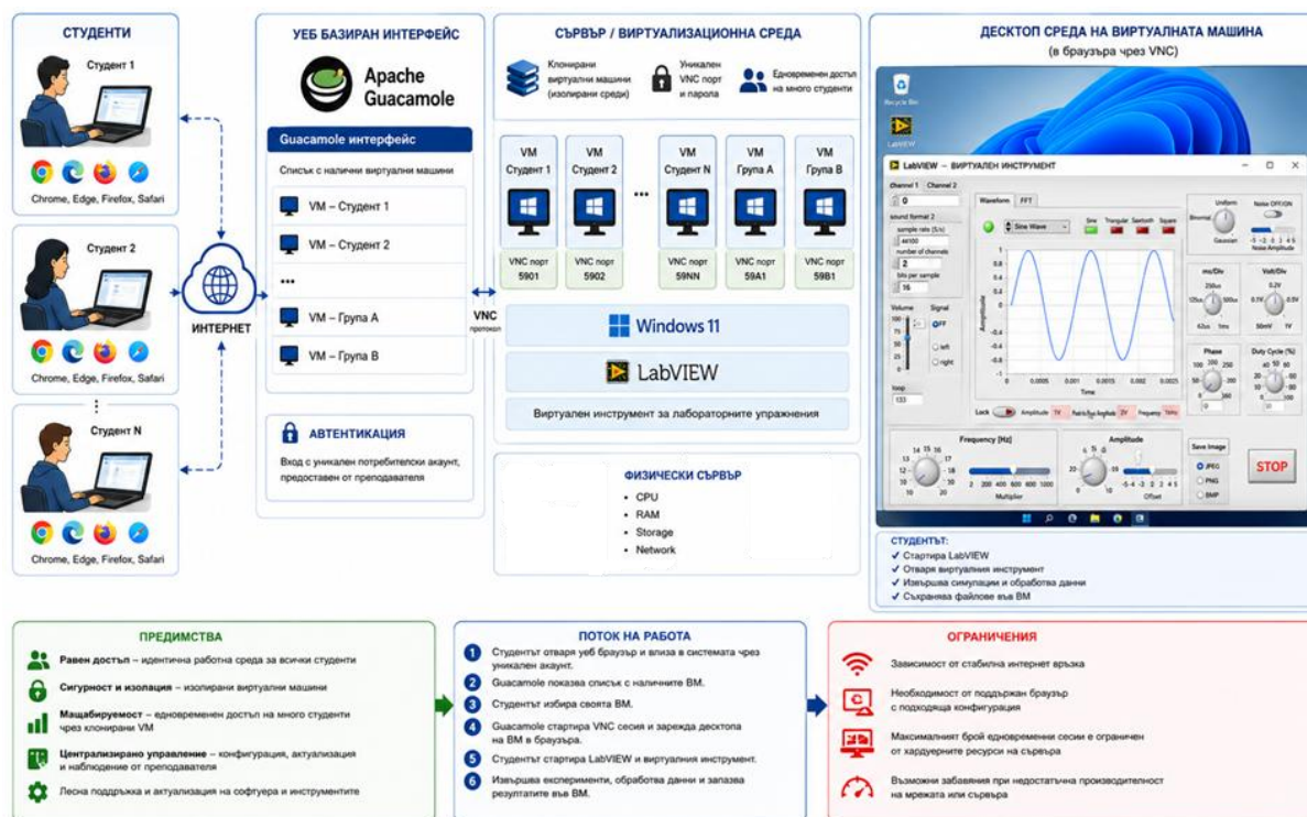
Фигура 3.79. Блокова схема на дистанционния достъп до виртуалната лабораторна среда
