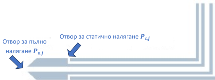
Фигура 4.1 Схематично разположение на отворите на тръбата на Пито
