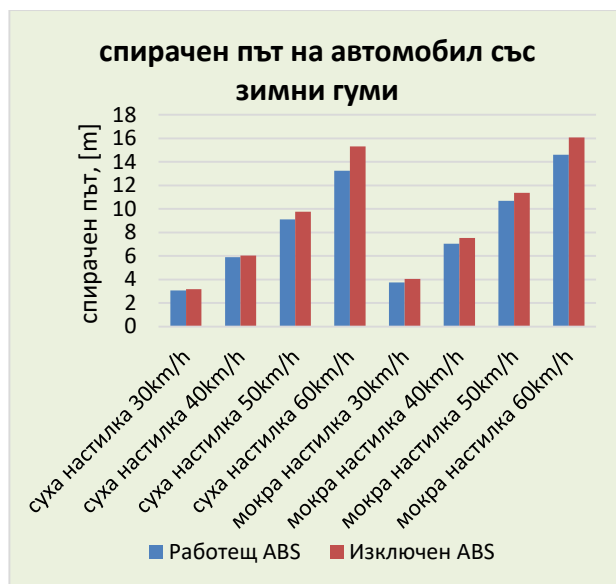
Фиг.3.18. Резултати на измерен спирачен път на лек автомобил, оборудван със зимни гуми с включен ABS и с изключен ABS
