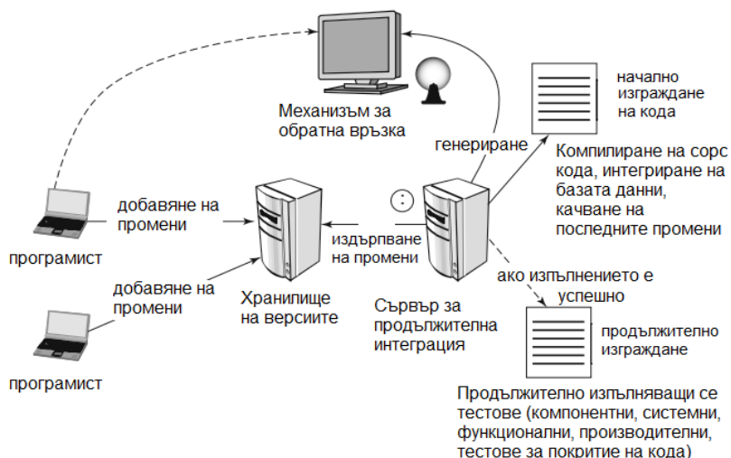
Фигура 6. Пълен цикъл на последователност при подхода на непрекъсната интеграция [Duvall, Glover'07]
