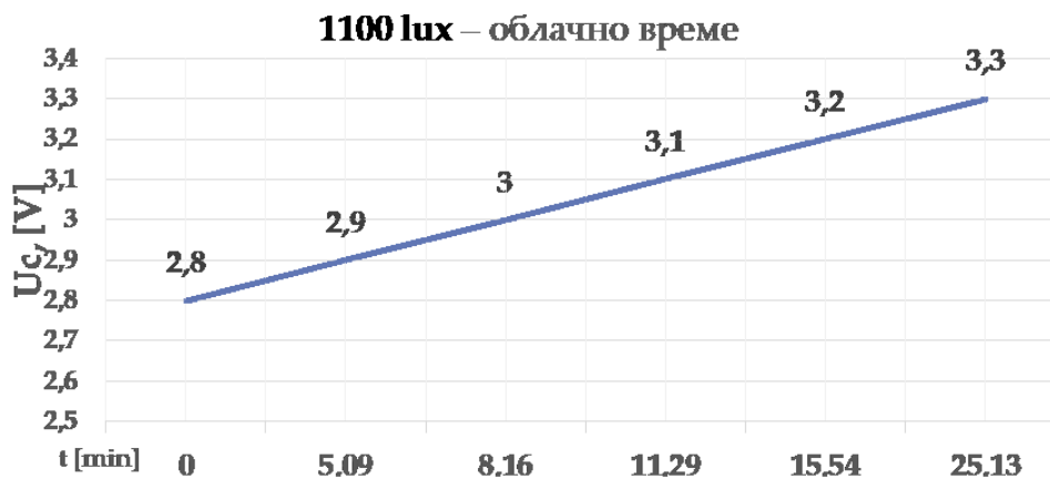
Фиг. 4.2.9. Диаграма на зареждане на суперкондензатора при облачно време
