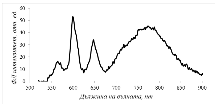
Фигура 54 Фотолуминесценция на поликристална проба (с източник на възбуждане 470nm) след рентгеново облъчване с продължителност 60min (проба 52)
