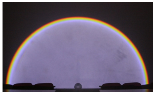
фиг. 31.2. Нормална полукръгла дъга с метализация. Фотоапаратът е настроен на f -stop 4.5, експозиция 1/2 секунда, ISO 1600
