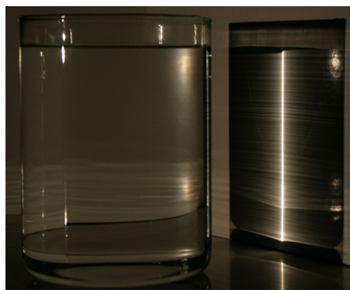
фиг. 2. Намиране на фокуса на цилиндрична водна леща – чаша с вода, екран
