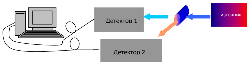
Фиг.2.3.1. Схема на апаратура за изследване оптичните свойства на твърди образци
